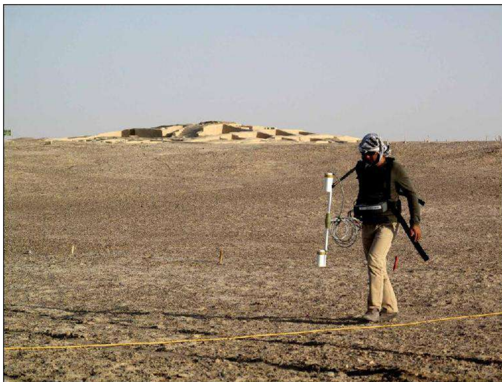
تصویر ۲. نحوه بررسی مغناطیس‌سنجی با دستگاه مغناطیس‌سنج سزیم در شهر سوخته
