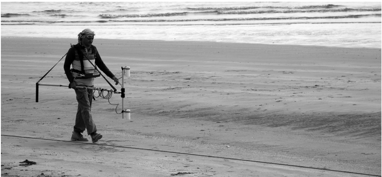
تصویر ۶- نحوه بررسی مغناطیس‌سنجی بر روی بقایای قلعه پرتغالی‌های بندر کنگ با دستگاه مغناطیس‌سنج سزیوم.
